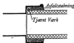
Samling ved Støbejernrørs Tilslutning til Kloakrør, Maal 1:10
